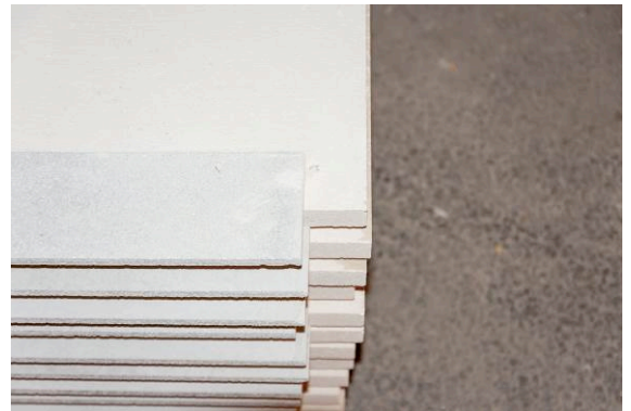
HECO_réf_internationale_Autriche_tunnel_Vorarlberg_plaques_coupe-feu.jpg Prêtes au montage : les plaques coupe-feu AESTUVER Tx de Fermacell AESTUVER.
