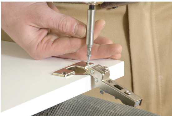
Vis HECO-UNIX positionnement de la pointe et vissage facile.jpg
