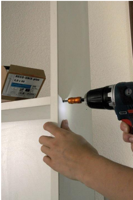
HECO-UNIX-plus_effet de contraction_3.jpg Au fur et à mesure du vissage, le pas de filetage variable de la vis contracte les éléments entre eux. Le vissage des éléments est rapide et demande peu d'efforts.
